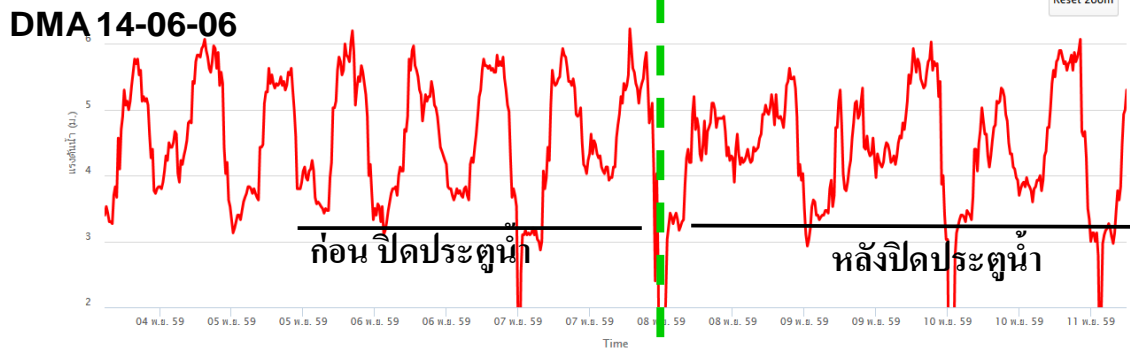
รูป 4.10 แรงดันใน DMA ก่อนและหลังดำเนินการปิดประตูน้ำ ปลายท่อประจានเส้นเก่า
